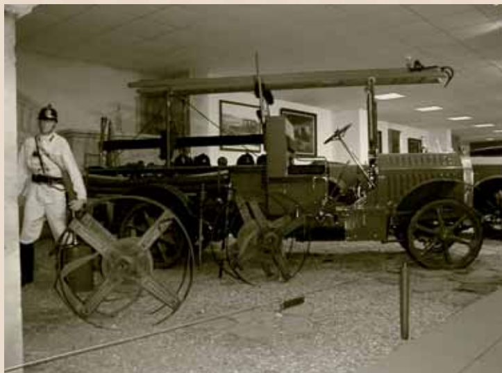
NW typ K byl vyroben pouze ve dvou exemplářích mezi lety 1909–1911. Byl vybaven benzínovým, vodou chlazeným, čtyřválcovým motorem nové konstrukce (se svislými válci) o obsahu 4940 cm 3 o výkonu 30 koní/22 kW při 1200/1 min. Měl 4 rychlosti
